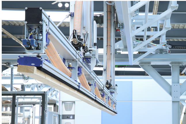
Система захвата большой площади FMP-S для послойной укладки строительной древесины
